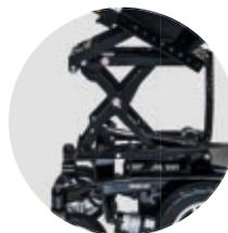
Inclinaison de l'assise électrique avec élévateur à ciseaux en option 300 mm
