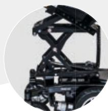
Inclinaison de l'assise électrique avec élévateur à ciseaux de 300 mm en option
