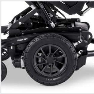
Roues motrices centrales pour une maniabilité maximale et des manœuvres précises
